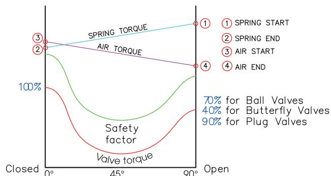
Per dimensionare l'attuatore si proceda nel modo seguente:
