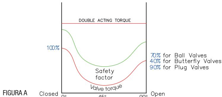
Per dimensionare un attuatore è necessario conoscere:
