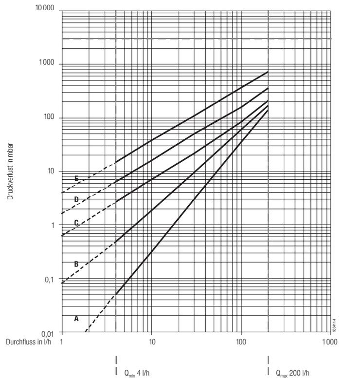
Viskositätslinien:            A = 5 mPa.s                    C = 100 mPa.s                    E = 500 mPa.s
