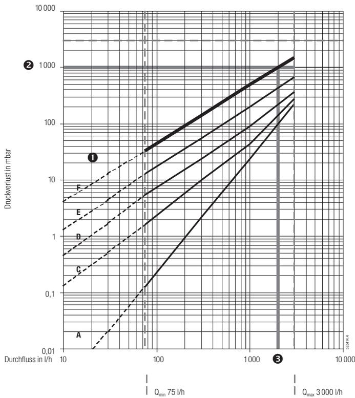
Messstoff Mineralöl, Viskosität 450 mPa.s,
