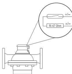
Der Reed-Impulsgeber RV ist im Rollenzählwerk integriert. Er eignet sich vorwiegend für die Ferntotalisierung. Für andere Anwendungen ist der induktive Impulsgeber IN zu bevorzugen.
