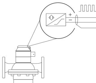
Induktiver Impulsgeber für industrielle Anwendungen. Steckbare Abtastsonde.
