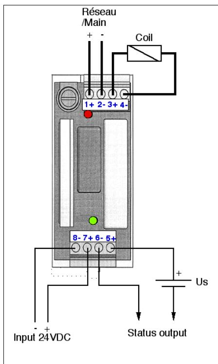
Tableau de fonctionnement du diagnostique / Status operation characteristics
