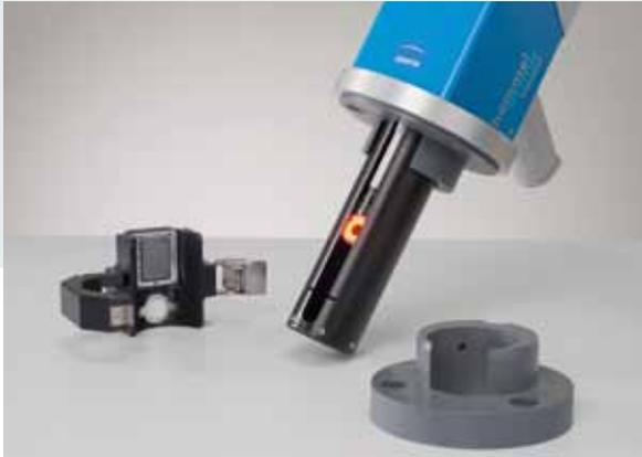
Der toposcan OR150 verfügt über eine Beleuchtungseinheit und einen Rauheitstaster zur Bestimmung der Oberflächenmerkmale. Das Raunormal erlaubt die sofortige Überprüfung des Systems. Die Zentrierplatte wird an den Durchmesser der Zylinderbohrung angepasst.
