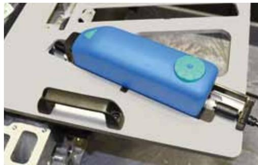
Mit dem HOMMEL-ETAMIC T30 wird Rauheit auf planen Flächen gemessen. Zur Positionierung des Vorschubs werden individuell angefertigte Aufnahmeplatten eingesetzt.
