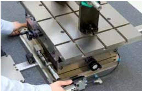
Der HOMMEL-ETAMIC waveslide misst Rauheit an wellenförmigen oder kubischen Werkstücken. Diese werden manuell über einen Messtisch mit Luftschlitten positioniert.
