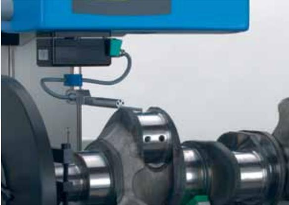
Für Messungen an tief liegenden Flächen oder zwischen Bunden kann der Taster ohne aufwändige Umrüstung um 90° geschwenkt werden. Die Abtastung der Oberfläche erfolgt quer zur Vorschubrichtung.
