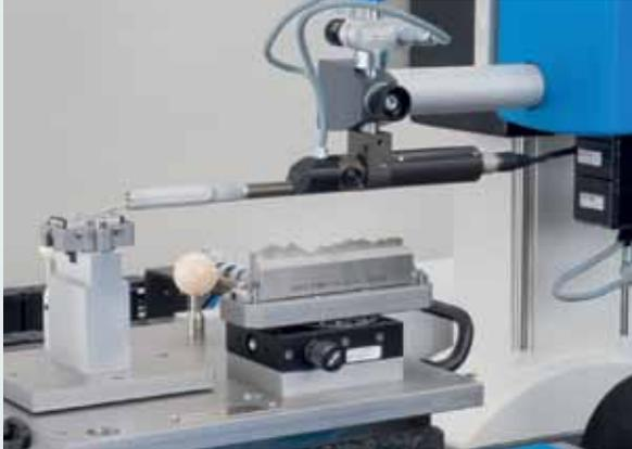
Die Kalibrierung des Messsystems erfolgt automatisiert über integrierbare Rauheits- und Konturennormale.
