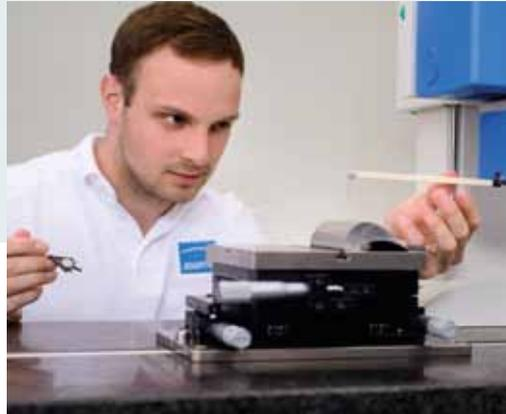
Die Tastarme lassen sich dank der Magnethalterung leicht und schnell wechseln. Sie werden mittels RFID Technologie elektronisch erkannt und automatisch der richtigen Messaufgabe zugeordnet.
