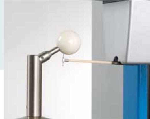
Die Kalibrierung des Gesamtsystems erfolgt über ein Kugelnormal und einen automatisierten Messlauf.
