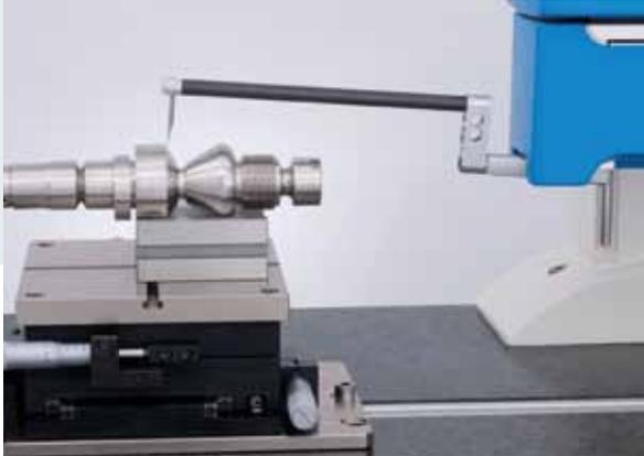
Der T8000 RC digiscan bietet einen großen Messhub für komplexe Konturenmessungen. Leicht wechselbare Tastarme mit Magnethalterung erlauben eine flexible Erweiterung des vertikalen Messbereichs.
