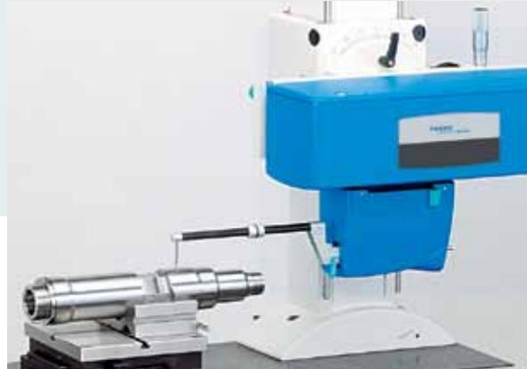
Die C8000 digital Konturenmessplätze verfügen über ein modernes, digitales Tastsystem. Die über den gesamten Messkreis konstant hohe Auflösung sorgt für höchste Wiederholpräzision und Messgenauigkeit auch bei kritischen Konturenmerkmalen.
