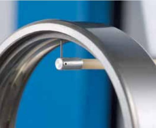
Die kombinierte Messung und Auswertung von Rauheit und Kontur erfolgt automatisiert in einem Messlauf.
