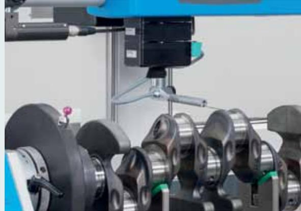
Für Rauheitsmessungen an Hublagern wird der Taster um 90° geschwenkt.
