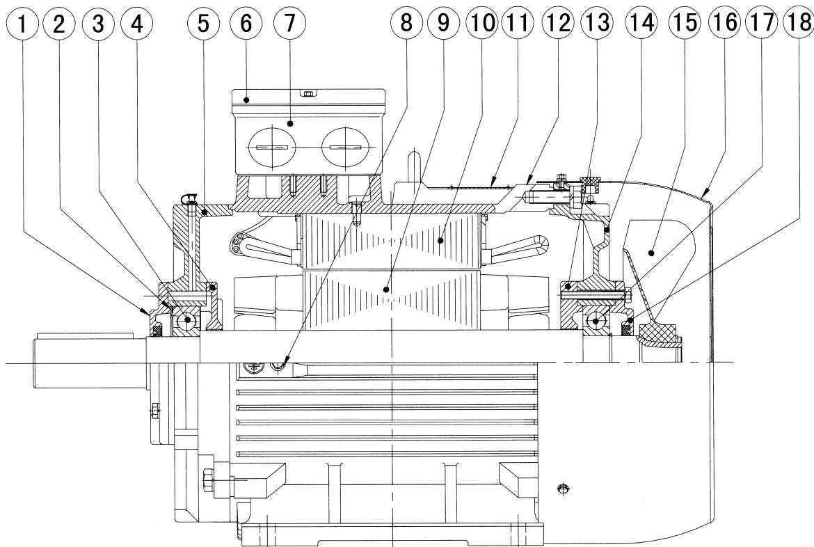
**SPECIFICHE, DISPOSIZIONE E DESCRIZIONE MOTORE TIPO 1L315-355**
