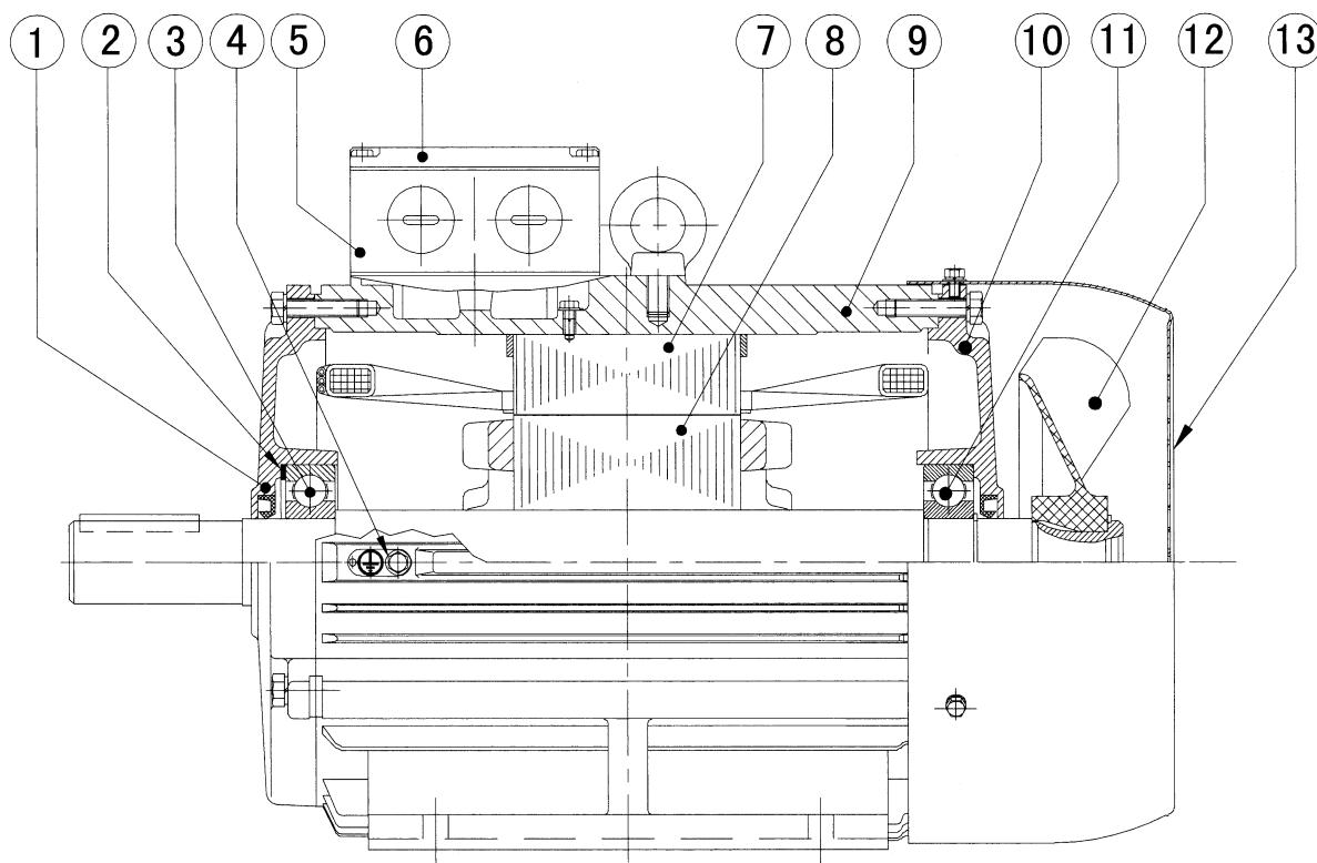
**SPECIFICHE, DISPOSIZIONE E DESCRIZIONE MOTORE TIPO 1L160-280**
