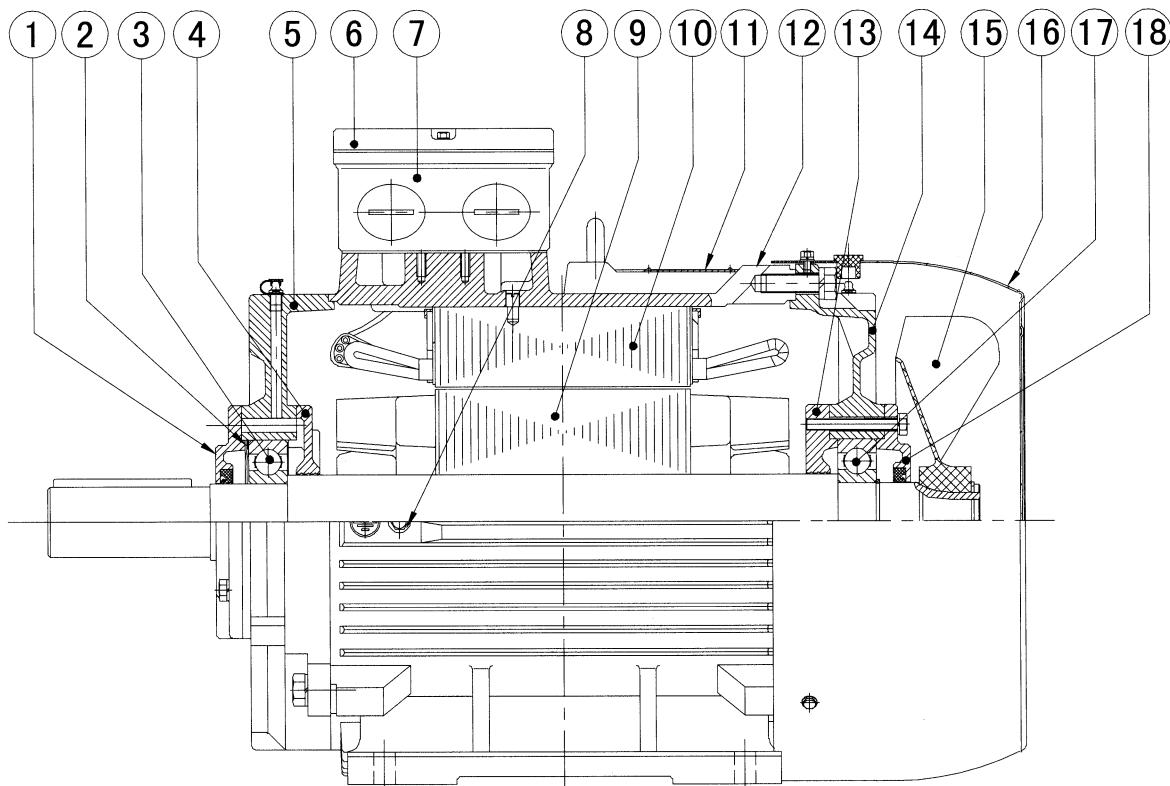
**SPECIFICHE, DISPOSIZIONE E DESCRIZIONE MOTORE TIPO 1L315-355**
