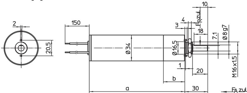
Befestigungsmutter für Einlochmontage bis max. Drehmoment 10 Nm anziehen.
