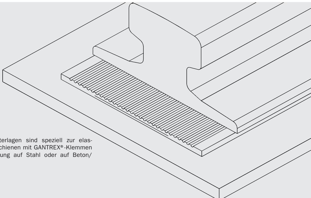
Die **GANTREX® MK6.0**-Unterlagen sind speziell zur elastischen Lagerung von Fahrschienen mit GANTREX®-Klemmen für kontinuierliche Befestigung auf Stahl oder auf Beton-/Stahl entwickelt worden.
