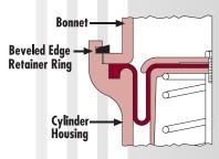
Fig. 27: Beveled Edge Retainer Plate
