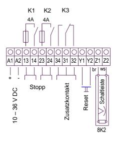
Bei Brücke Y1, Y2 = Automatikreset.
