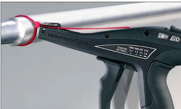
1. Spannen (Tension): Der Kabelbinder wird wie gewohnt gespannt.
